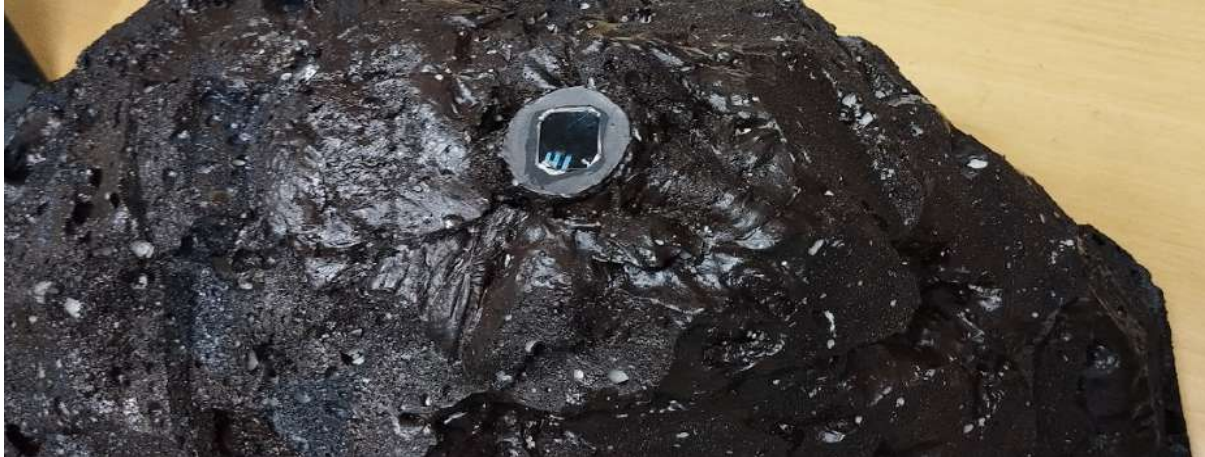
Figura 5. Maqueta de bomba volcánica con electrónica y óptica para simular el interior incandescente
